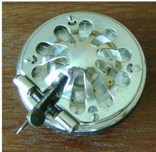
Soundbox 'akustisk kontaktmikrofon' - Mekanisk energi til akustisk energi.
